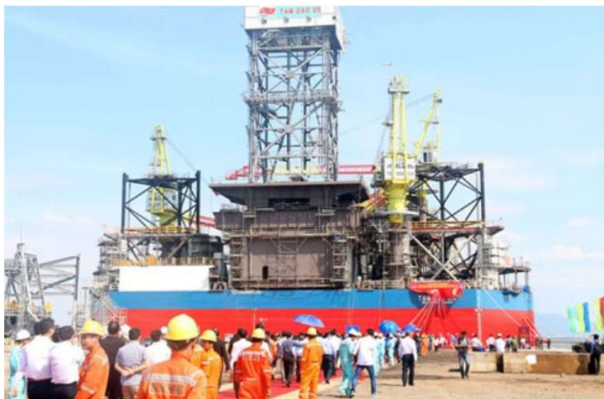
Hình 4-11 Dàn khoan Tam Đảo 05 tự kích nổi ở vùng nước sâu 120m, chế tạo tại Việt nam, khai trương ở tỉnh Bà Rịa – Vũng tàu. Nguồn: VNA.
