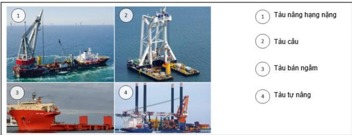
Hình 5-7: Vận chuyển và lắp đặt các bộ phận của móng
