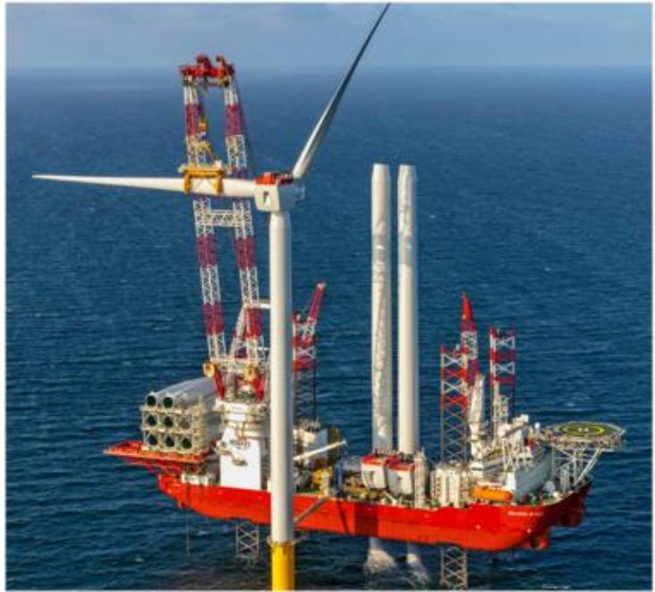
Hình 7-8: Tàu lắp đặt tua bin gió điển hình - Cảng hạ lưu PTSC
