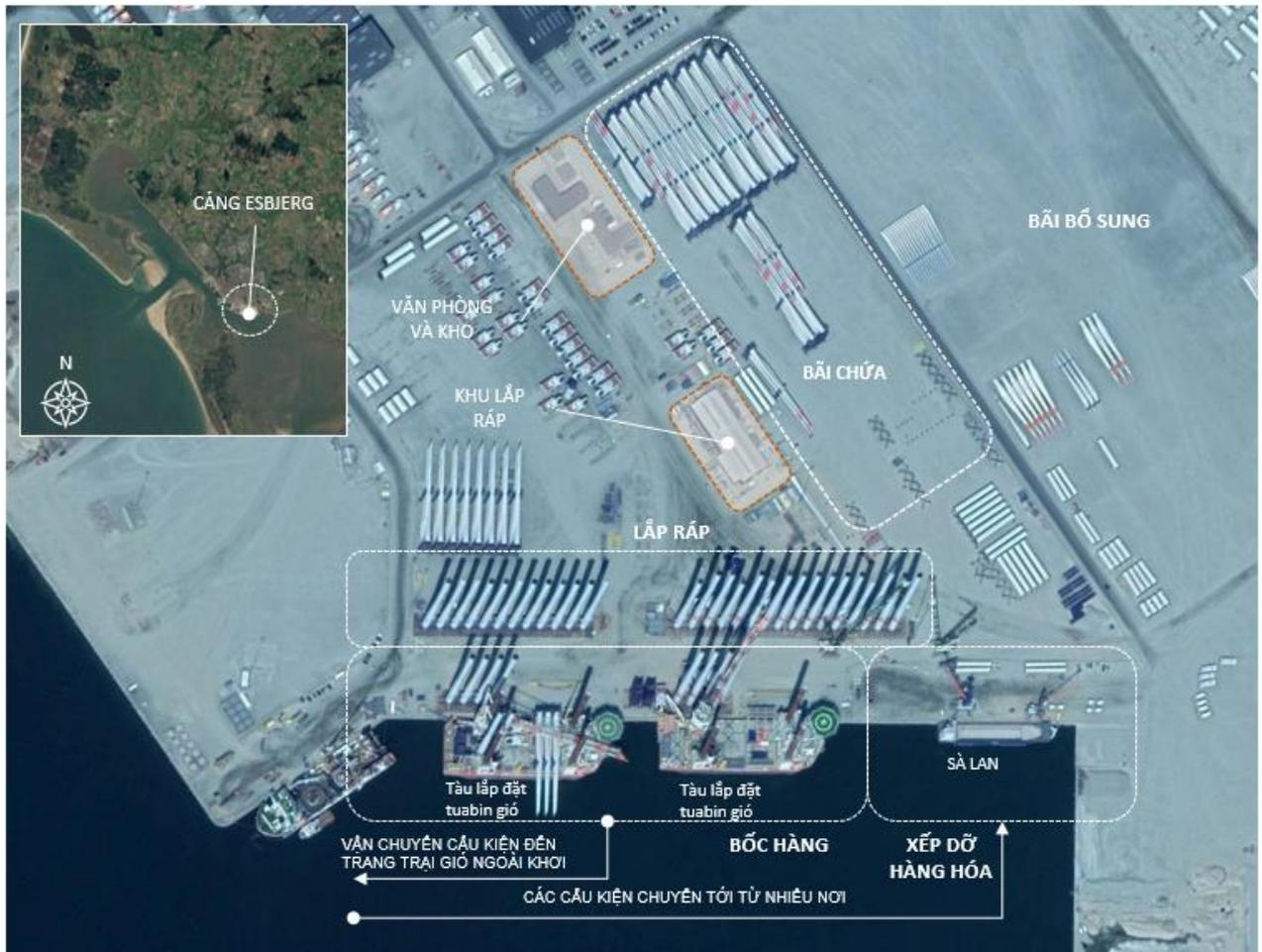
Hình 5-2: Bố trí điển hình tại cảng xây dựng (Cảng Esbjerg)
